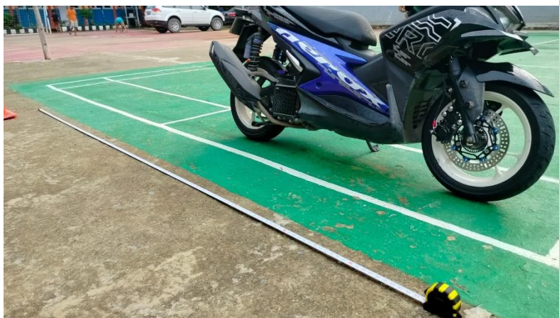
Gambar 1. Pengujian jarak pengereman dengan Material ban soft compound
