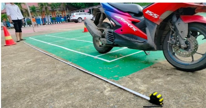
Gambar 2. Pengujian jarak pengereman dengan Material ban soft compound
